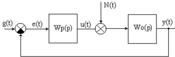
2) Выведем передаточную функцию от  $N(t)$  к  $e(t)$ , записав уравнения, связывающие выходы объекта и регулятора со входами:
