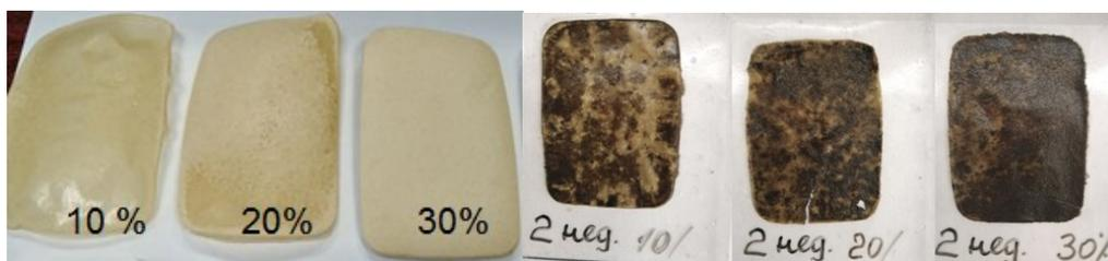
Рисунок 3 – Образцы с различным наполнением ПВС микроцеллюлозой до и после двухнедельного пребывания в компосте
