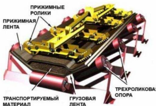
Рисунок – Прижимное устройство “мягкого” типа конвейера фирмы Scantainventor Conveyor Sicon
