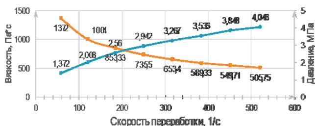
Рисунок 1 – Получение входных данных для моделирования процесса заполнения пресс-формы (CeastVIEW 5.94 4D)
