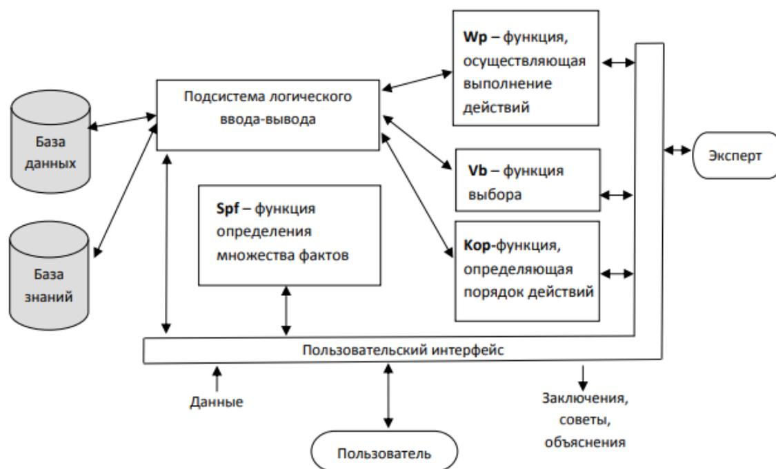
Рисунок 1 - Структура экспертной системы
