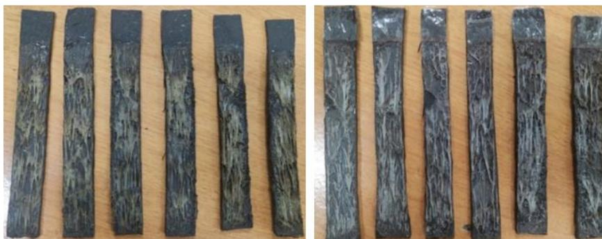
Рисунок 8. Влияние природы окислителя вулканизирующей группы на тип расслаивания совулканизированных соединений
