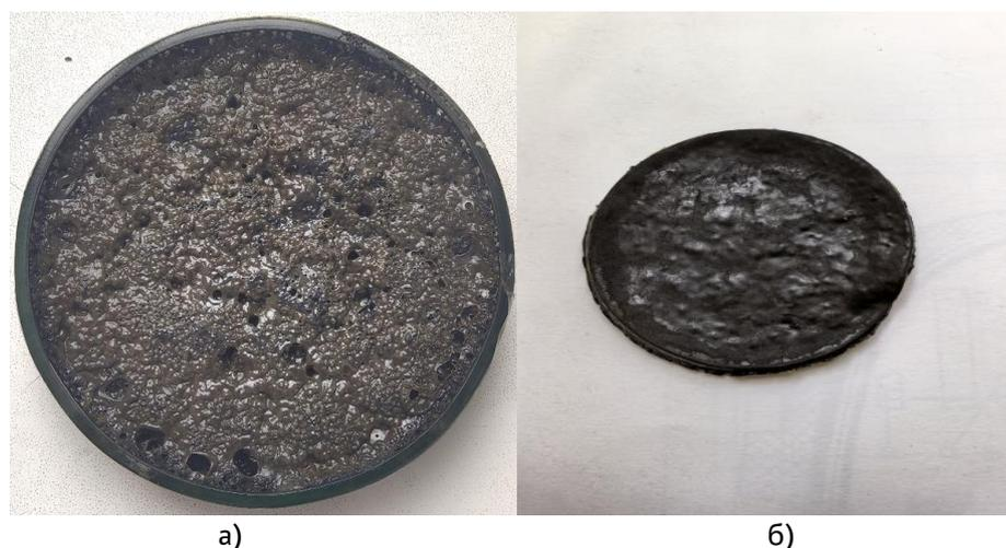
Рисунок 5. Вид двухслойного отвержденного покрытия:
