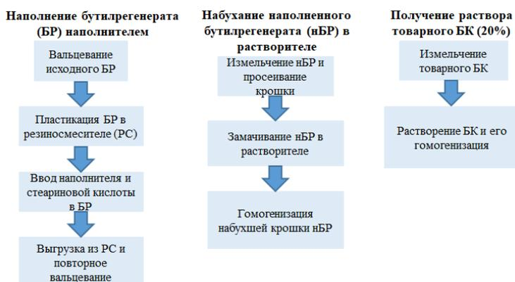
Рисунок 2. Схема подготовки матрицы товарного БК и наполнителя мастики (крошки нБР или СБС)
