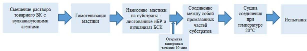
Рисунок 6. Схема получения совулканизированного соединения «регенерат-резина» и «регенерат-регенерат» промазкой мастичным составом
