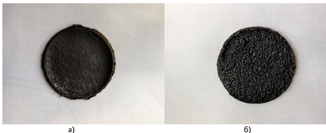
Рисунок 4. Вид финишный (а) и грунтового (б) слоев на основе отвержденного товарного БК
