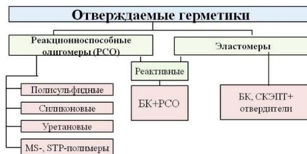
Рисунок 1. Виды отверждаемых герметиков
