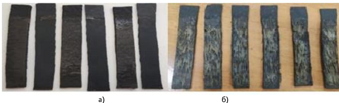
Рисунок 7. Влияние природы субстрата на тип расслаивания совулканизированных соединений а) «регенерат - резина», б) «регенерат - регенерат»
