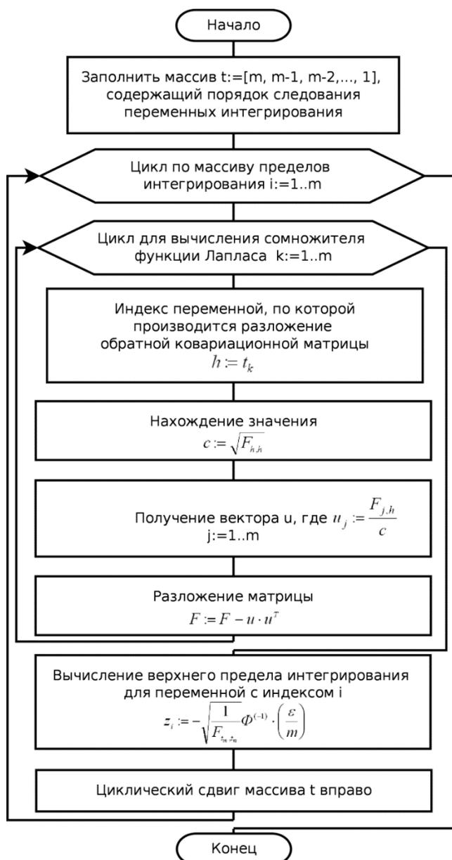
Рисунок 3. Декомпозиция блока «Вычисление пределов интегрирования»
