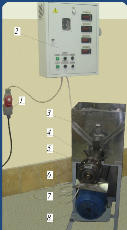
Рис. 2 Экспериментальный образец одношнекового маслопресса: 1 – источник электропитания; 2 – щит управления; 3 – загрузочный бункер; 4 – орган регулировки зазора; 5 – зерновая камера; 6 – станина; 7 – сборник масла; 8 – электропривод
