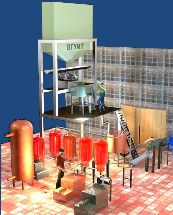
Рис. 1. Объемно-планировочное решение линии производства растительных масел с предварительной экструзионной обработкой сырья
