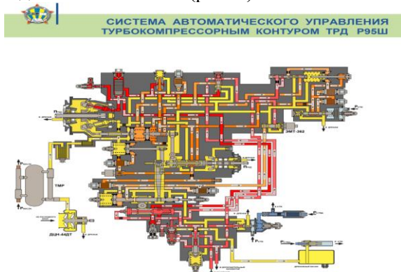
Рис. 5 Принципиальная схема системы автоматического управления двигателем
