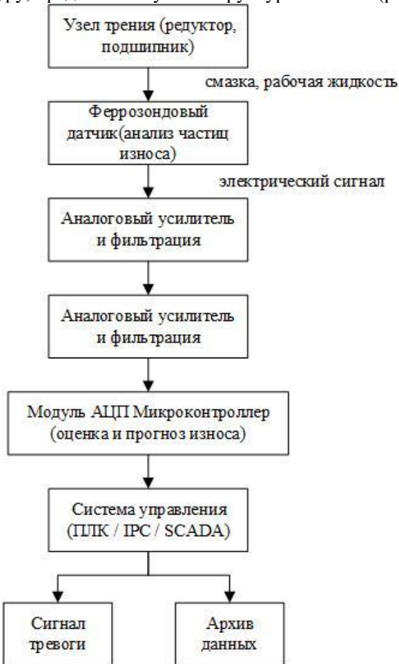
Рис. 1. Обобщенная структурная схема системы контроля состояния приводов с использованием феррозондового датчика
