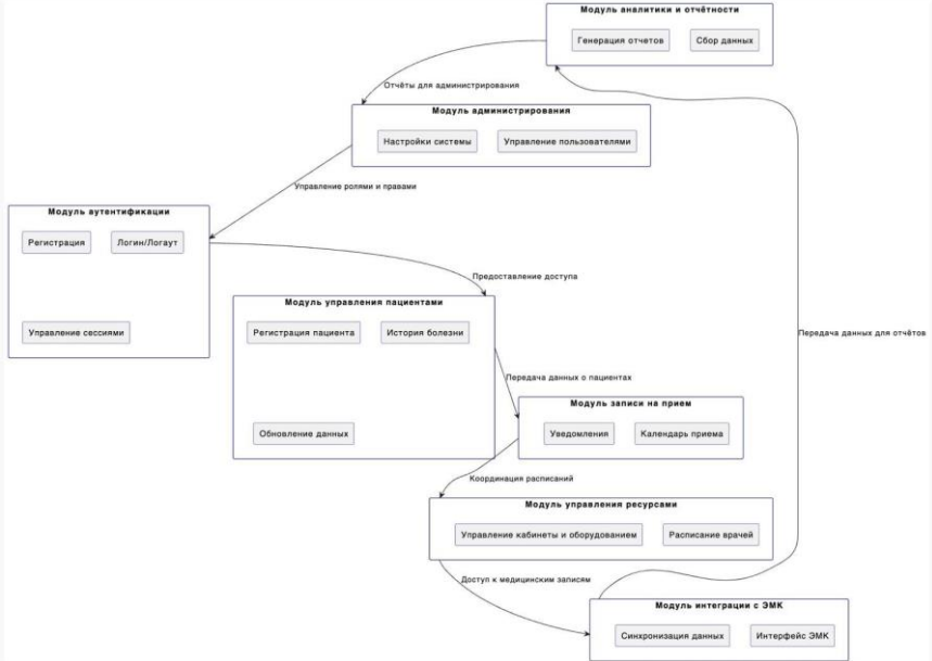
Рисунок 3 – Схема микросервисной архитектуры комплекса
