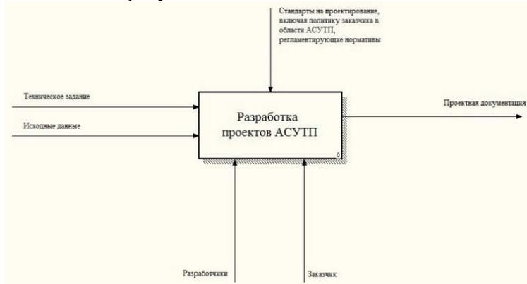
Рисунок 1 – Контекстная диаграмма процесса разработки проектной документации на АСУТП
