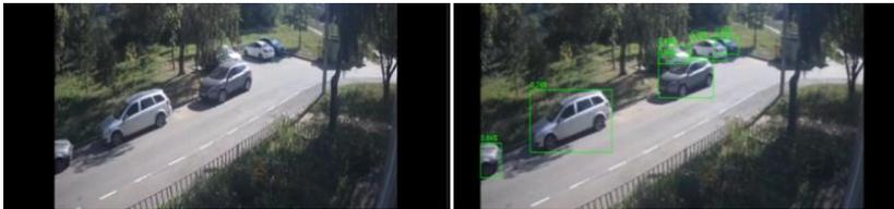
Рисунок 18 – Результат работы нейронной сети семейства YOLO
