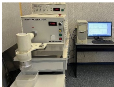
Рис. 3 - Информационно-измерительная система на базе прибора «Do-corder DCE330» и измельчителя для определения твердозерности пшеницы
