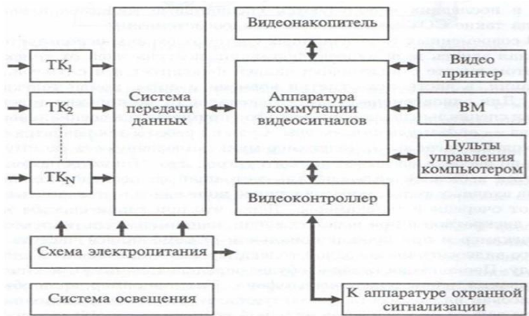
Рисунок 2 - Типовая структурная схема системы видеонаблюдения
