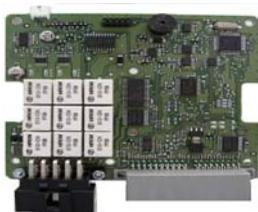
Плата блока управления электропакетом ВАЗ 2170.
