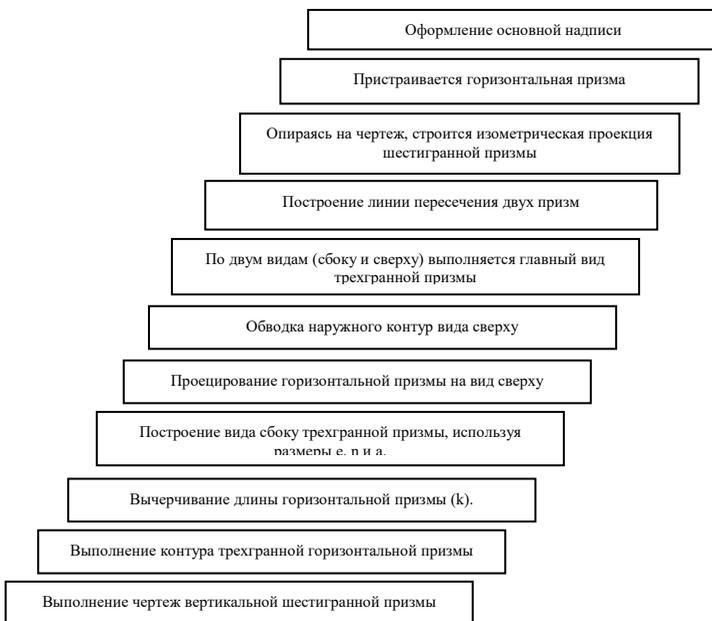
Рисунок 1 - Схема выполнения графической работы по пересечению граных тел
