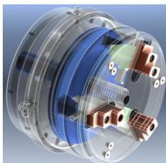
Рисунок 1 – Общий вид конструкции быстродействующего пневматического кулачкового патрона со встроенным пневмоцилиндром
