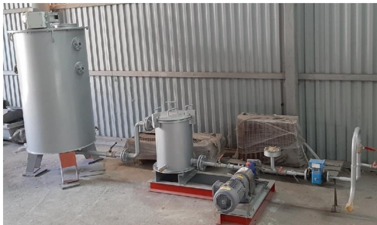
Рис. 2. Установка для ввода в комбикорма жидких компонентов
