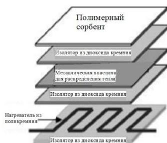
Рисунок 1.12 – Основные слои микропластинки, изготовленной по КМОП-технологии и используемой в качестве микроконцентратора.[94]
