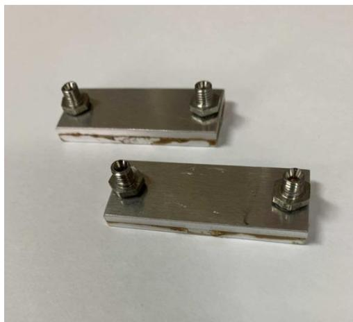
Рисунок 2.28 – ПК (моно- и трехкапиллярного типа) в виде МЭМС-колонок планарного типа
