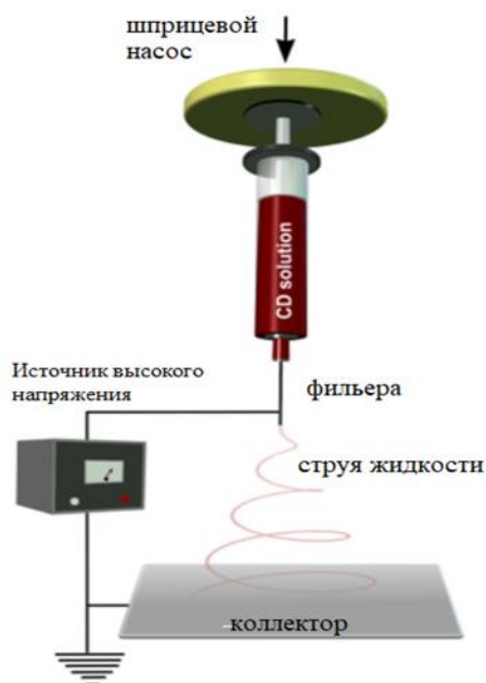
Рисунок 6. Электроформование полимерного нановолокна
