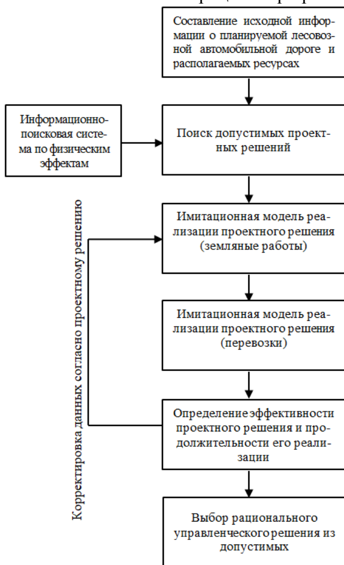
Рисунок 2. Методология системы интеллектуальной поддержки принятия проектных решений в сложных технических системах транспортного освоения лесосырьевых баз
