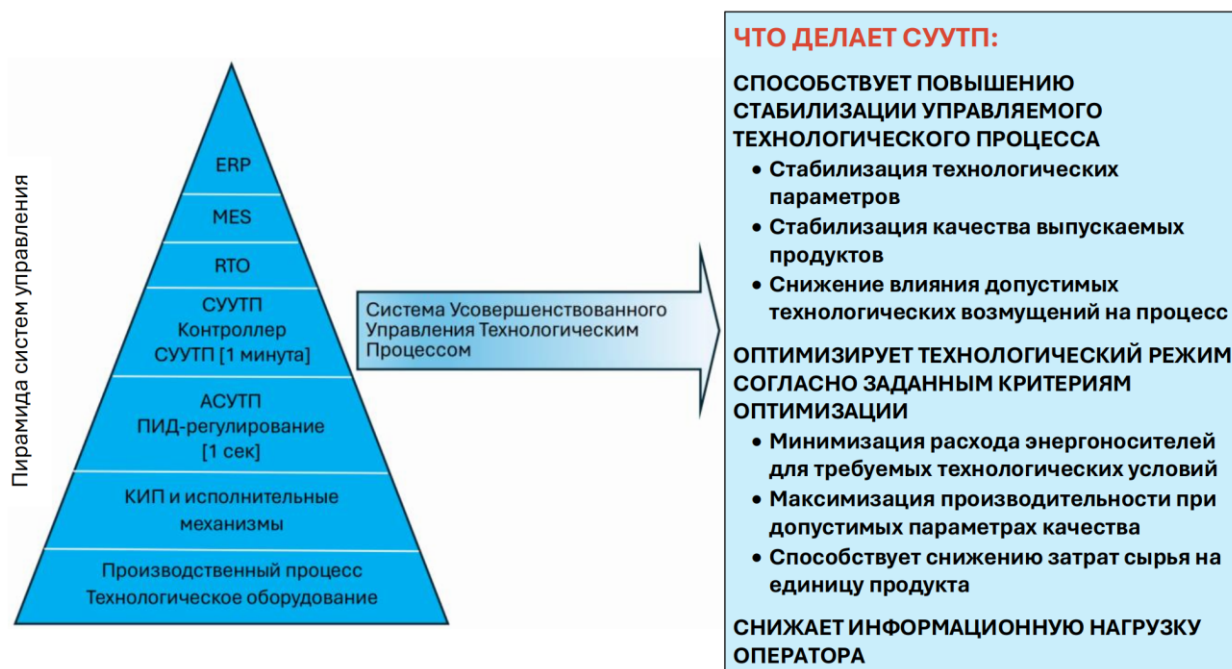
Рисунок 1.2 – Система СУУТП – это программно-аппаратный комплекс
