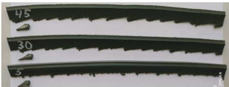
Рисунок 3.7. Фотографии профилей ВЭМ на основе СКС-30АРКМ15, содержащих 10 мас.ч. смЖК
