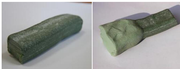
Рис. 1.1. Бентонитовый гидроизоляционный шнур до контакта с водой и через 2-е суток после контакта с водой.
