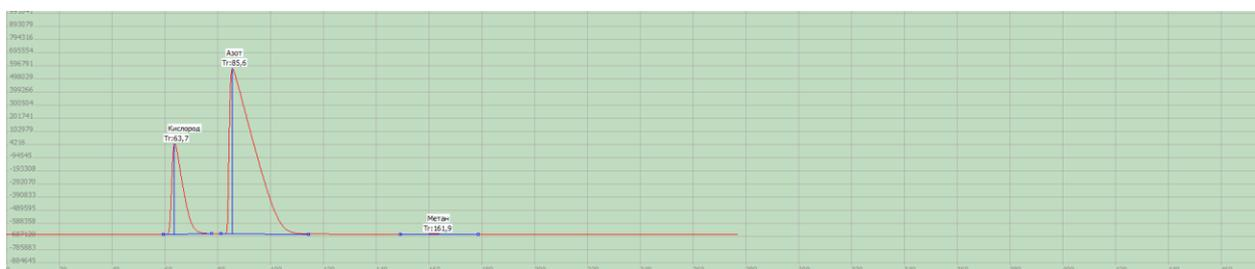
Рисунок 62 – Хроматограмма, полученная при определении  $O_2$ ,  $N_2$ ,  $CH_4$  (газ-носитель - гелий. температура колонки  $50^{\circ}C$ , температура детектора и планарного микродозатора  $50^{\circ}C$ )
