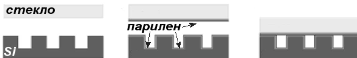
Рисунок 31 – Схема создания микрофлюидной колонки с использованием парилена в качестве НФ (пояснения в тексте)
