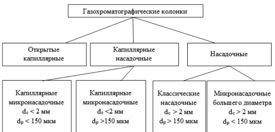
Рисунок 1 – Классификация хроматографических колонок
