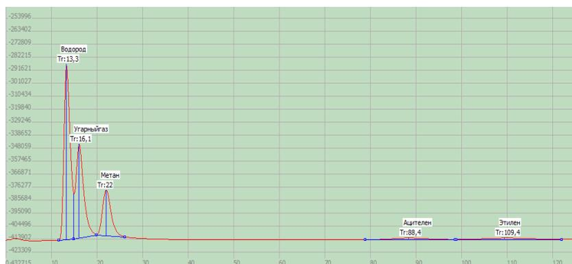
Рисунок 72 – Хроматограмма, полученная при определении водорода, метана, этана, этилена и ацетилена с использованием модуля А (температура термостата колонок 40 °С, расход газа-носителя (воздуха) – 5-7 см<sup>3</sup>/мин, объем вводимой пробы – 50 мкл)
