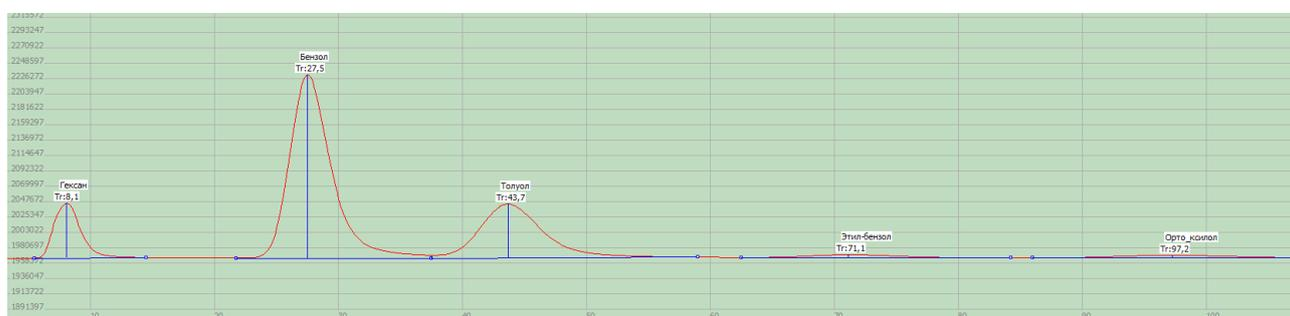
Рисунок 68 – Хроматограмма, полученная при определении примесей ароматических углеводородов (бензол, толуол, этилбензол) (а) с использованием аналитического модуля № 2
