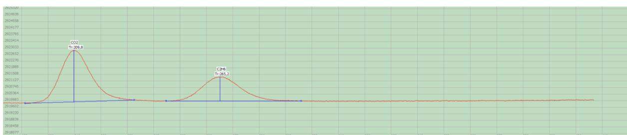
Рисунок 63 – Хроматограмма, полученная при определении  $CO_2$  и  $C_2H_6$  (газ-носитель гелий. температура колонки, детектора и планарного микродозатора  $50^{\circ}C$ )
