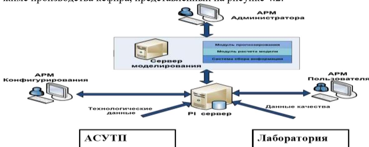
Рисунок 4.2 Структура комплекса программного обеспечения для расчета показателей качества кефира
