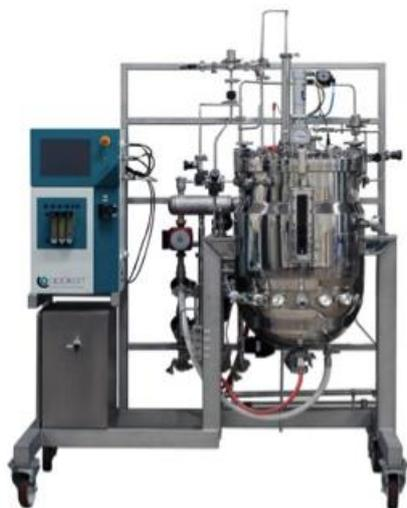
Рисунок 1.4 – Промышленный биореактор с мешалкой
