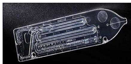
Рисунок 1.11 – Микрочип (картридж) системы «CTSelect»
