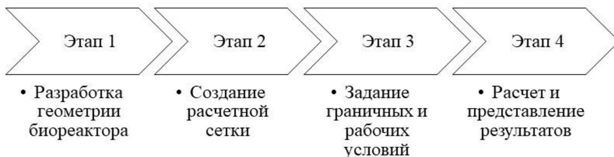
Рисунок 4.13 – Основные этапы моделирования в рамках вычислительной гидродинамики
