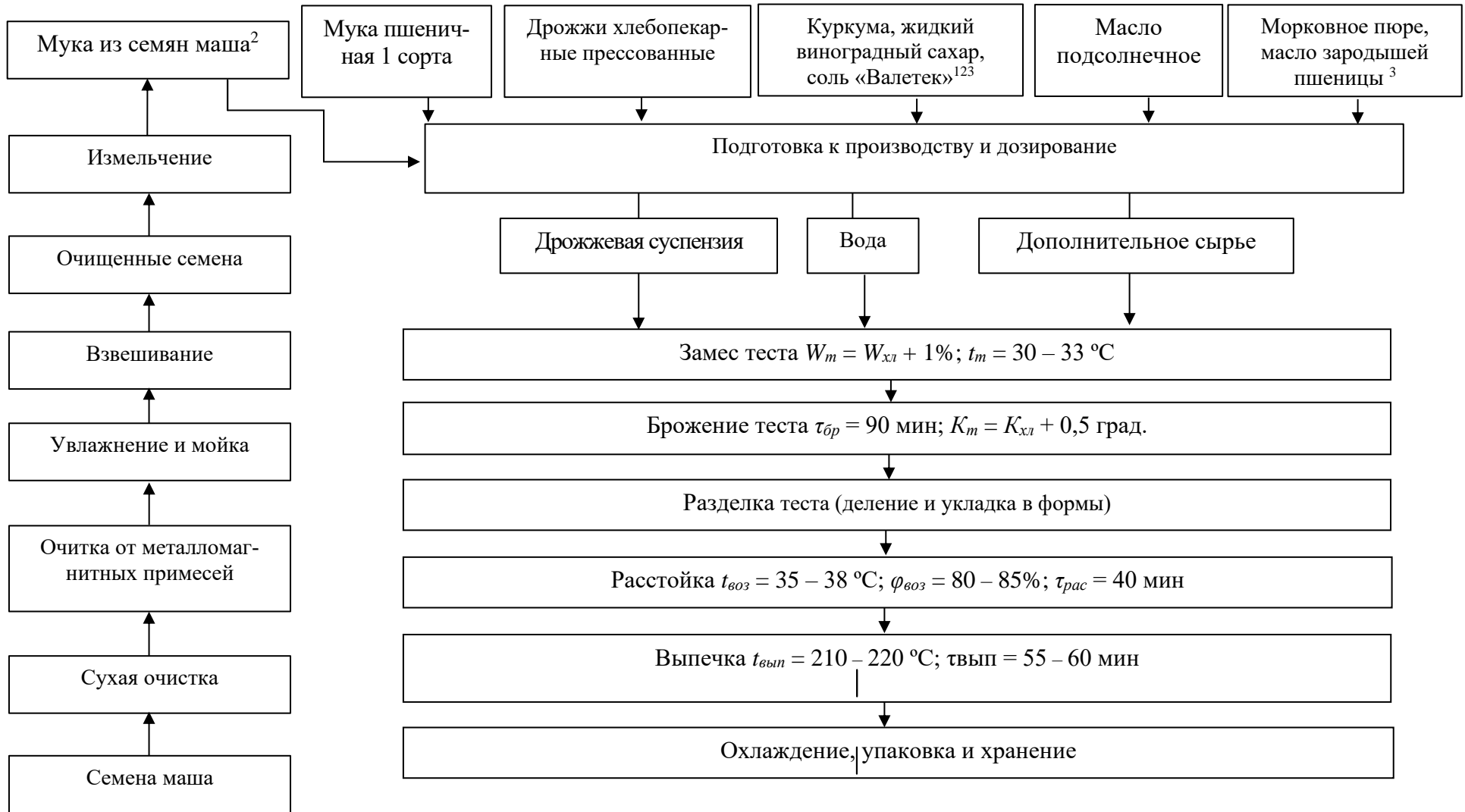
Рисунок 19 – Функциональная схема производства обогащённого хлеба: «Мерита» 1 , «Курмаш» 2 , «Кроха» 3
