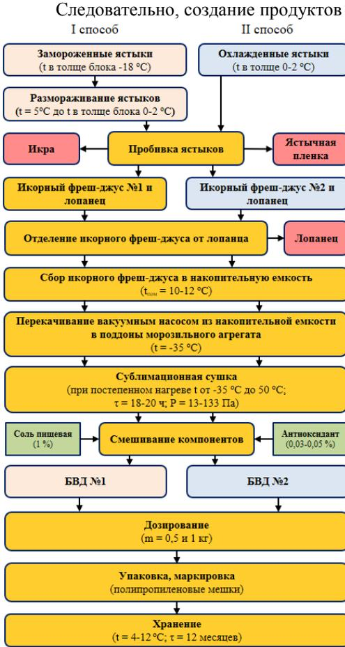
Рисунок 9 - Технологическая схема получения белково-витаминных добавок на основе икорного фреш-джуса № 1 или 2
