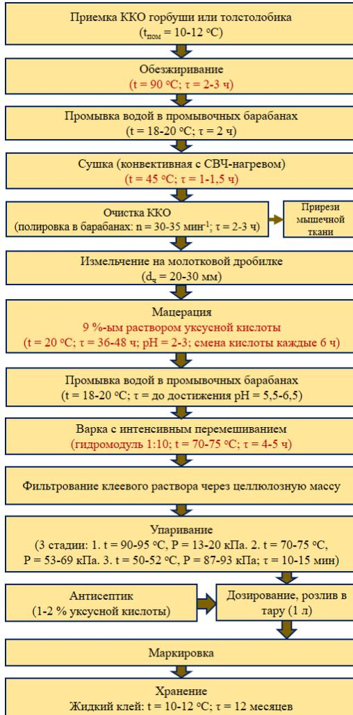
Рисунок 15 - Технологическая схема получения рыбного клея из ККО горбуши или толстолобика
