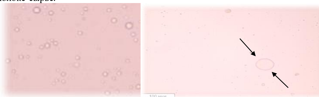
Рисунок 7 - Распределение жировых частиц молока после низкочастотной кавитационной обработки молока-сырья
