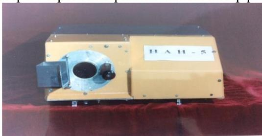
Рисунок 22 – Экспериментальный образец ИК-анализатора НАН - 5
