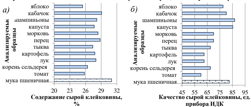
Рисунок 4 – Влияние замены 7 % пшеничной муки в модельном тесте ТП на количество (а) и качество (б) отмываемой клейковины
