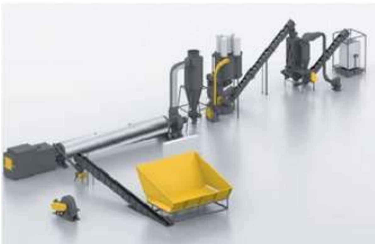
Рисунок 1.7 – Линия сушки и гранулирования свекловичного жома
