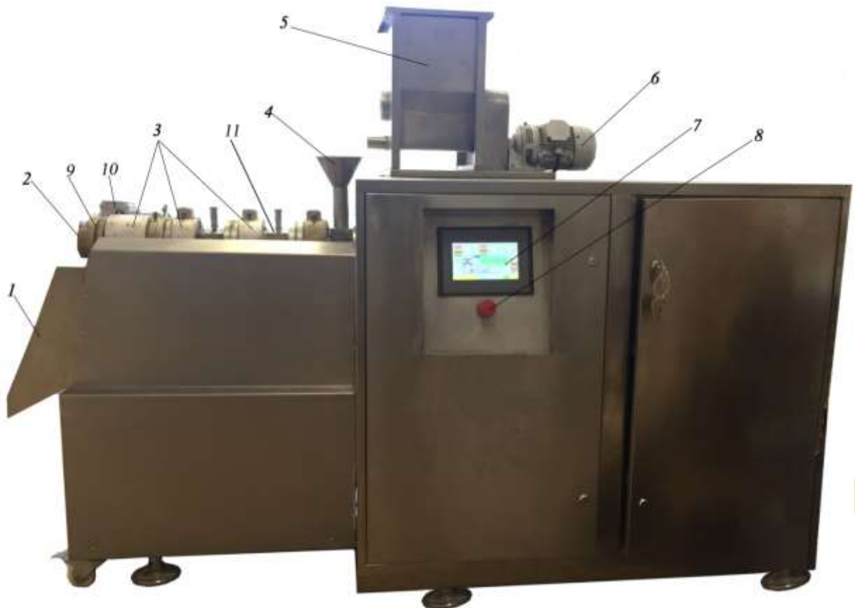
Рисунок 2.1 – Экспериментальный пресс-гранулятор: 1 – сливной желоб, 2 – формовочная матрица, 3 – греющие элементы рабочей камеры, 4 – загрузочная воронка, 5 – шнековый питатель, 6 – привод шнекового питателя, 7 – сенсорный пульт управления, 8 – кнопка аварийной остановки, 9 – перфорированная камера, 10 – привод ножа, 11 – рабочая камера
