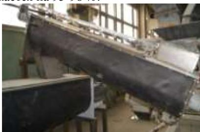
Рисунок 4 – Кондиционер-пропариватель
