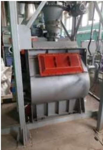
Рисунок 29 - Смеситель вакуумный
