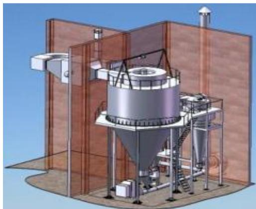
Рисунок 1.15 - Сушильная установка (сушилка) распылительного типа
