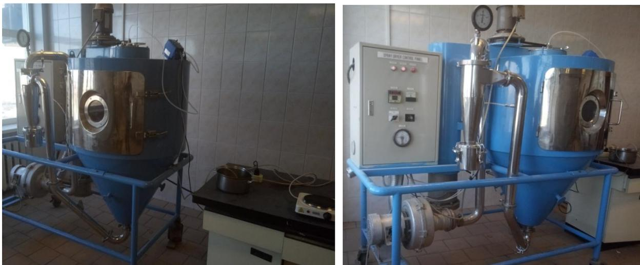
Рисунок 6.2 – Установка распылительной сушки
