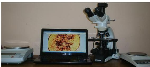
Рисунок 3.16 – Общий вид экспериментальной установки для исследования процессов формирования капиллярно-пористой структуры частиц при распылительной сушке
