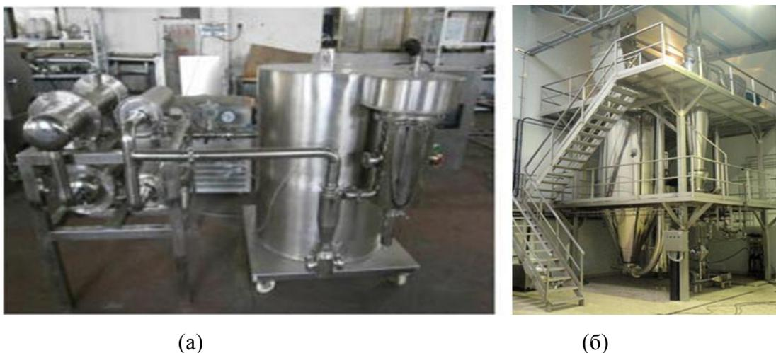
Рисунок 1.12 - Распылительные сушилки: (а) – YC-015A (HONGSEN, Китай) и (б) – сушилка Riera Nadeu SA (Испания)
