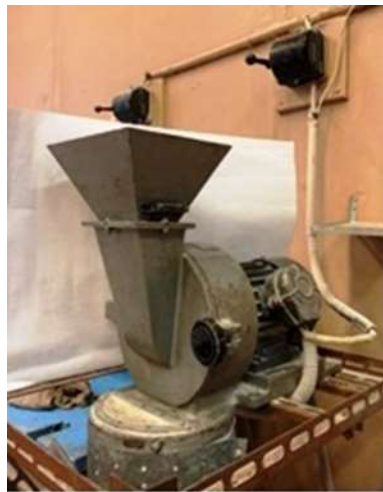
Рисунок 3.22 – Установка для измельчения продукта после термо-химической обработки зерна
