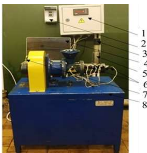
Рисунок 3.20 – Установка для термо-химической обработки зерна:
