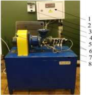
Рисунок 12 – Установка для термохимической обработки зерна: 1 – шкаф управления; 2 – вольтамперметр; 3 – преобразователь давления; 4 – ПК с SCADA; 5 – система передачи давления; 6 – термоэлектрические преобразователи; 7 – тахометр; 8 – экструдер КЭШ-2.
