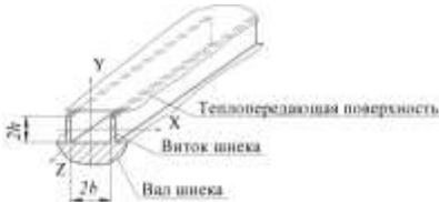
Рис. 12. Схема развертки шнекового канала
