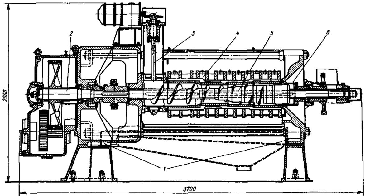
1. 1 – привод пресса; 2 – станина; 3 – регулятор питания; 4 – зерный барабан; 5 – шнековый вал; 6 – регулировочное устройство конусного типа.
