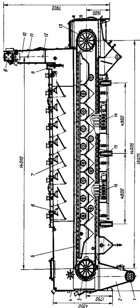
1. 1 – лопастной шнек; 2 – загрузочный бункер; 3 – регулировочный шибер; 4 – корпус; 5 – сетчатый ленточный транспортер; 6 – форсунка; 7 – грабельные рыхлители; 8 – ведомый вал; 9 – шлюзовый затвор; 10 – выводной бункер; 11, 12 – ограничители; 13 – ведущий вал; 14, 16 – насосы; 15 – опоры.
