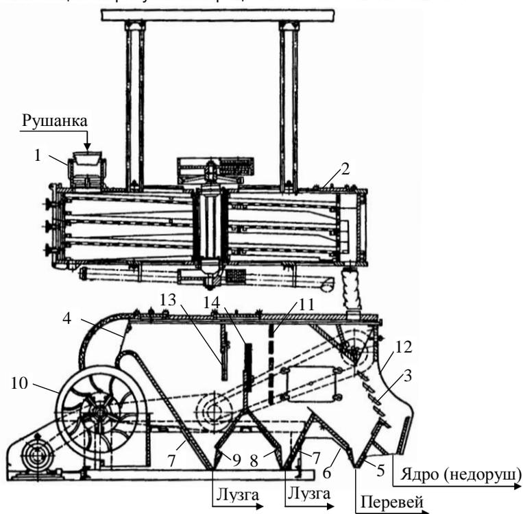
1. 1 – приемный рукав; 2 – шиберный механизм; 3 – жалюзи; 4 – рассев; 5 – карман для перевея; 7 – карманы для лузги; 6, 8, 9 – клапаны; 10 – вентилятор; 11 – аспирационная камера; 12 – решетка; 13, 14 – перегородки.
