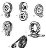
зубчатая цилиндрическая прямозубая – ...;<br>зубчатая цилиндрическая косозубая – ...;<br>зубчатая коническая прямозубая – ...;<br>зубчатая винтовая – ...;<br>червячная – ...;                                 |                        |
