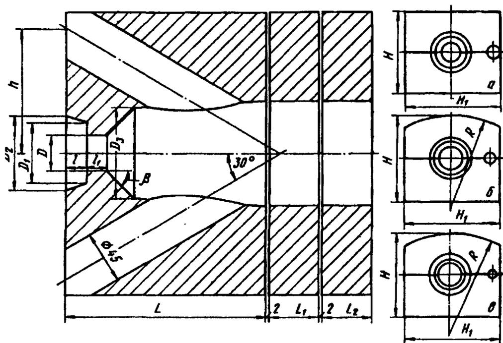
122. **Конструктивные размеры (мм) огнеупорных горелочных блоков для горелок**
