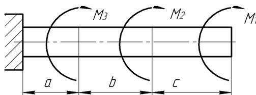
Рис.Схема задания для расчета стержня на кручение
