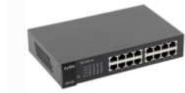
При работе коммутатора среда передачи данных каждого логического сегмента остается общей только для тех компьютеров, которые подключены к этому сегменту непосредственно. Коммутатор осуществляет связь сред передачи данных различных логических сегментов.
